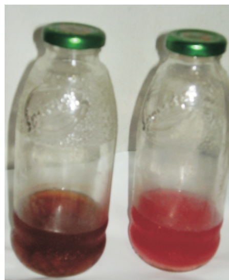
Fig. 3. Extractos acuosos de betarraga, a los 120 días de almacenamiento en condiciones de oscuridad y a 4 °C para el grupo A, se observa una coloración rojiza oscura y para F en el cual las condiciones fueron 68 °C y presencia de luminosidad (198 lux), donde se observa una coloración rojo claro
